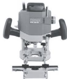
de cantos, etc.) Si el cliente quiere fresar los paneles en un equipo propio, valen los mismos principios que para los tipos anteriores del procesamiento. Sin embargo, fresando hay que tener en consideración las características mecánicas (grosor mínimo) de los paneles CETRIS®. La velocidad recomendada del corte oscila entre 25 – 35 m/seg.
