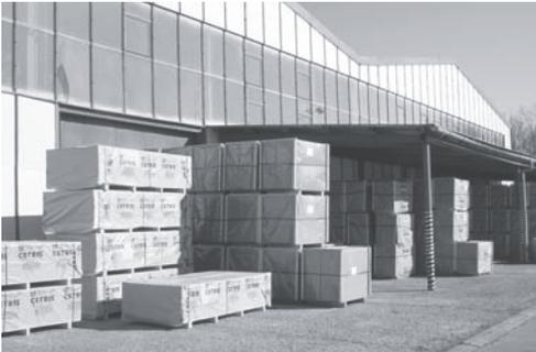
Los paneles de madera-cemento CETRIS® se almacenan en paletas de madera de transporte que permiten la manipulación con la carretilla de horquilla. La fijación se asegura amarrando los paneles en la paleta con una cinta transversal, las cintas longitudinales se ponen sólo por pedido del cliente.
