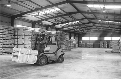
Die zementgebundenen Spanplatten CETRIS® werden auf Holzpaletten aufgestapelt, um die einwandfreie Handhabung mit einem Gabelstapler zu ermöglichen. Die Platten werden mit dem Umreifungsband umlegt. Die Umreifung erfolgt standardmäßig quer, oder auf Wunsch der Kunden auch in der Längsrichtung.
