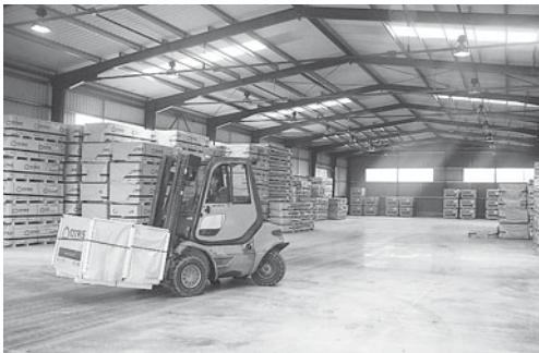
Les panneaux de particules liées au ciment CETRIS® sont mis sur des palettes en bois. Les dimensions standardisées des palettes permettent leur manipulation à l'aide de chariots élévateurs. Nous assurons la fixation des panneaux sur la palette à l'aide d'un ruban de serrage mis à travers, un autre ruban mis longitudinalement n'est utilisé que sur demande du client.
