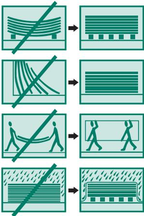
Die CETRIS®-Platten sind in trockenen und überdachten Räumen so zu lagern, dass sie vor dem Einbau keine Feuchtigkeit aufnehmen können. Paletten mit den CETRIS®-Platten mit gleichen Abmessungen können übereinander in höchstens 5 Lagen gelagert werden.
