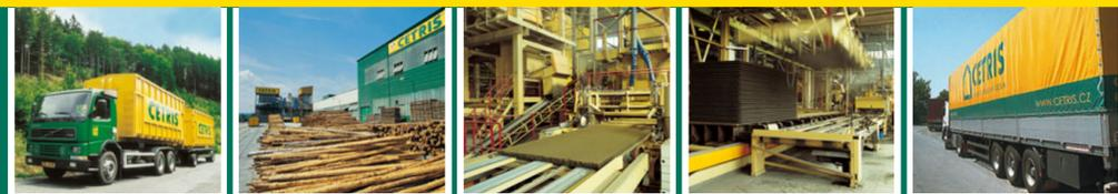
La plaque de construction CETRIS® est obtenue par pressage d'un mélange de copeaux de bois, de ciment Portland et d'adjuvants d'hydratation. La surface de la plaque est lisse et présente une couleur gris ciment.
