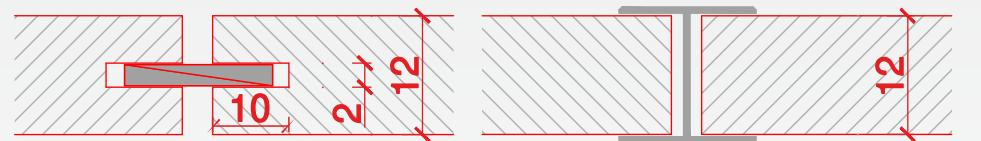
Hrany desek CETRIS® tvořící vodorovnou spáru pro opláštění mohou být výrobcem ofrézovány – je vytvořena drážka pro vložení pero (šířka 2 mm, hloubka 10 mm). Možné je také použití desek CETRIS® s kolmou hrany (bez úpravy) – v tomto případě je nutné do vodorovné spáry vložit H profil (plast).
