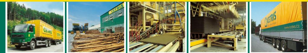
Панели CETRIS® производятся путем прессования смеси деревянных стружек, цемента марки „Портланд“ и гидротационных добавок. Поверхность плит ровная, цвет цементно-серый.
