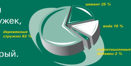
Прежде всего, цементно-стружечные панели предназначены для использования в качестве конструкционного материала в тех случаях, где от материала одновременно требуется его сопротивляемость влажности, прочность, негорючесть, экологическая и гигиеническая безопасность. Панели CETRIS® не содержат ни асбеста, ни формальдегидов. Они проявляют высокую стойкость против воздействия на них насекомых и плесени. Панели являются негорючими и обладают хорошей звукоизоляцией.
