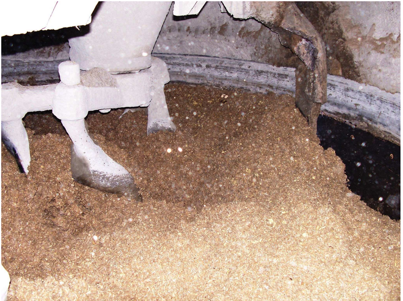
Obr.3 – Mísení směsi pro výrobu cementotřískových desek
